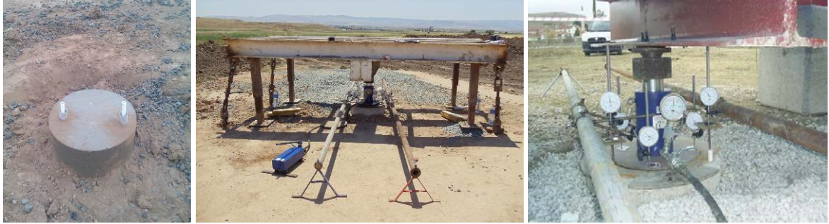
Şekil 4. Modulus Yüklemesi Testi
