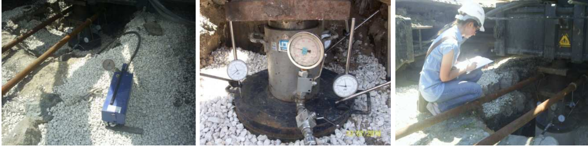
Şekil 7. Darbeli kırmataş kolon ve taş kolon yükleme testleri (Kurt, 2011)
